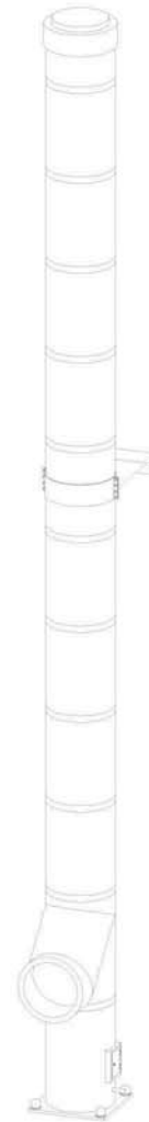
Übersichtsisometrie FSB mit Gebäudeanbindung
